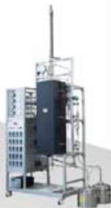
吊篮式高温高压 生物质热解/煤燃烧装置
